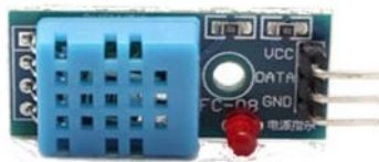
3.12 сурет - DHT11 датчигі шағын тақтаға дәнекерленген көрінісі
